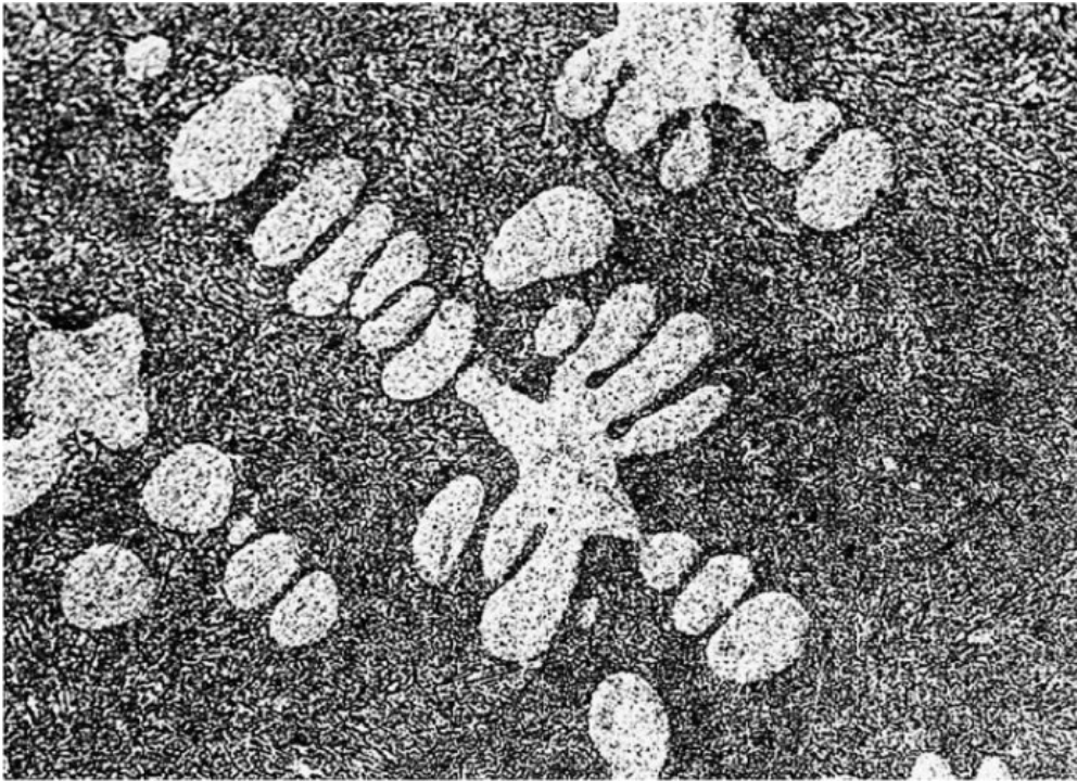
Bild 3: Gefüge einer mit Strontium veredelten G-AlSi-Legierung mit 10 % Si (Kokillenguss) © GIESSEREI LEXIKON
