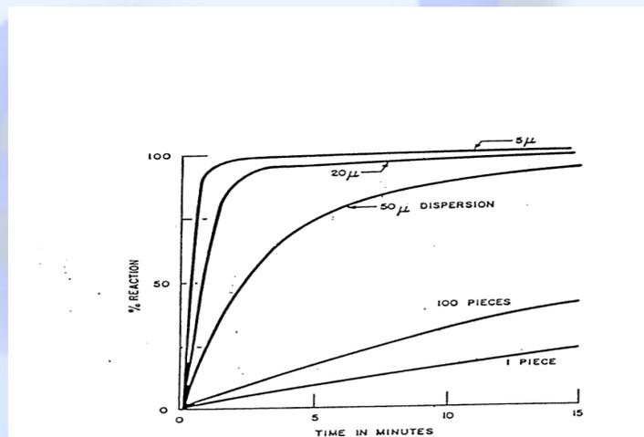
Somit kann die extrem hohe Oberfläche der feinteiligen Natriumdispersion in einer Vielzahl von chemischen Reaktionen vorteilhaft eingesetzt werden.
